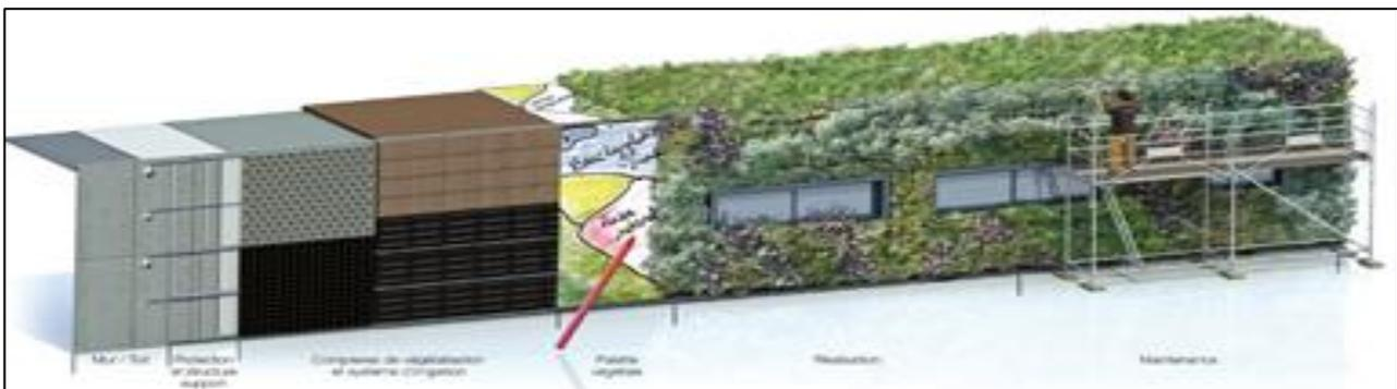
Fig. 39 (II.3). Détails constructive murs végétalisés
