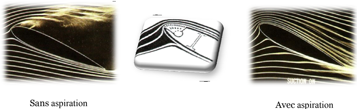
Figure (II-46) : Aspiration au niveau du bord d'attaque.
