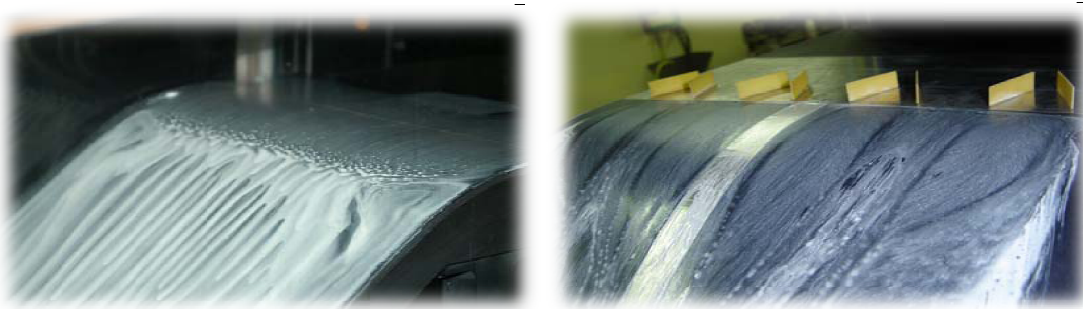
Figure (I-59) : Visualisation par enduit visqueux sur la paroi basse de la veine. A gauche : cas de référence. A droite : cas contrôlé.
