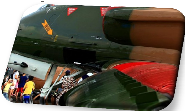
Figure (I-54) : TA-4SU Super Skyhawk avec générateur de tourbillons.
