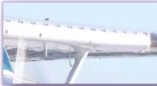
Figure (I-51) : Cessna 182K Modele 1967 avec générateur de tourbillons.
