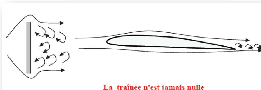
Figure (I-25) : Traînée et forme du profil.
