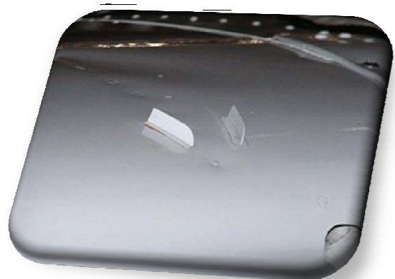
Figure (I-55): Micro Dynamique générateur de tourbillons monter sur l'aile d'un Cessna 182K.
