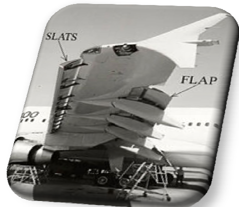
Figure (I-43) : Becs et volets d'un Airbus A310.
