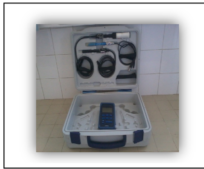
Figure 6 : Schéma montrant le multi-paramètre utilisé (type WTW W issenschaftlich).
