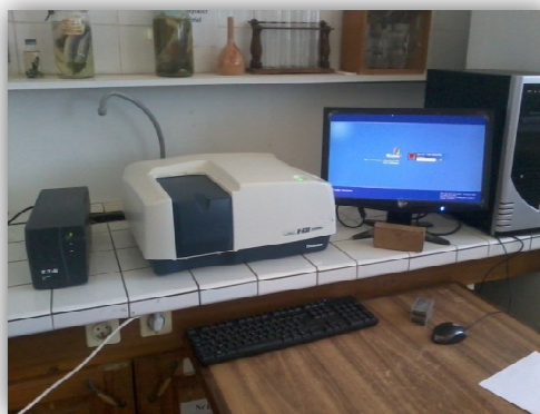
Figure 7 : Photo montrant le spectrophotomètre UV-Visible utilisé (JASCO V-630).
