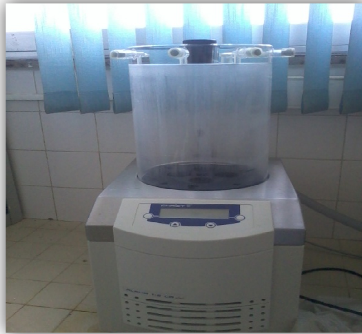
Figure 5 : Schéma montrant le lyophilisateur utilisé (type CHRIST ALPHA 1-2 LD).
