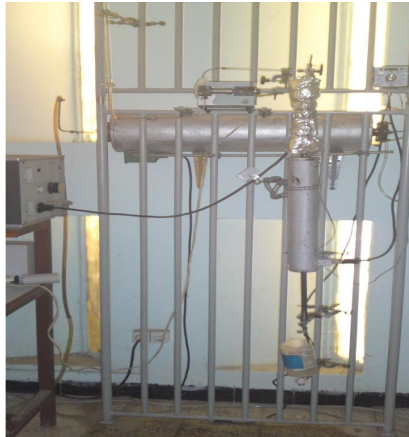
Figure IV.2 : Dispositif expérimental pour la déshydratation du Glycérol.
