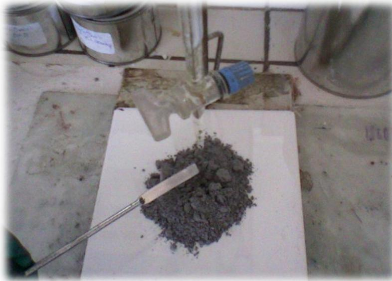
**Figure (5.1) :** Méthode de la mesure de point d'écoulement.
