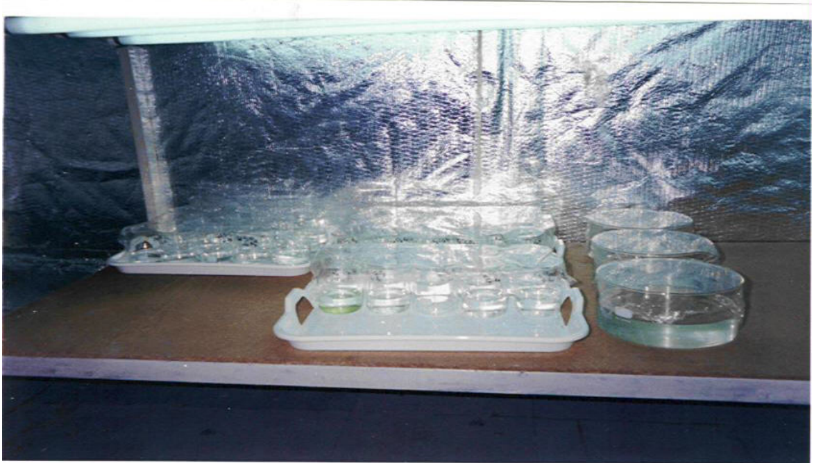
Figure 4.8 : Dispositif expérimental du test de toxicité à long terme
