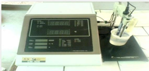
Figure 25 : Appareil d'un conductimètre
