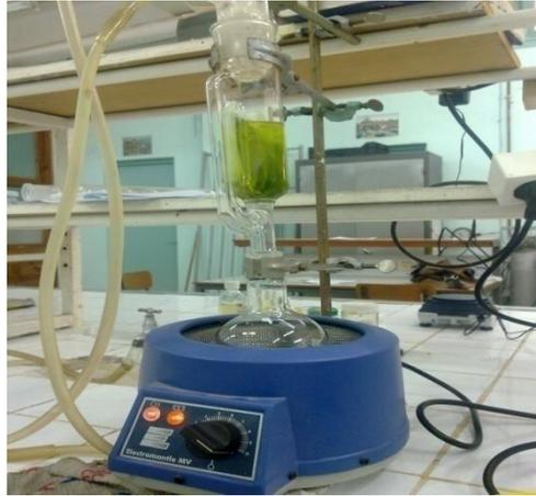
Figure 28 : montage de soxhlet pour la délipidation
