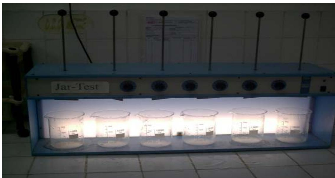
**Figure III .5:** Dispositif expérimental de la coagulation-floculation « Jar-test ».
