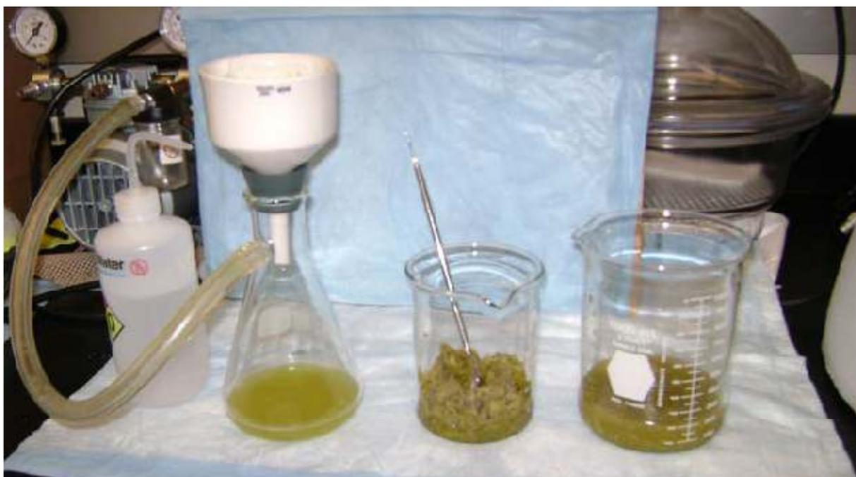
**Figure III .3 :** Filtration du NE en utilisant une pompe.
