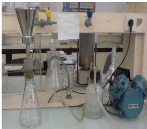
Figure III-2 : système de filtration
