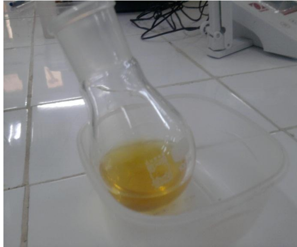
Figure 14: Huile végétal des baies de lentisque extraite avec soxhlet
