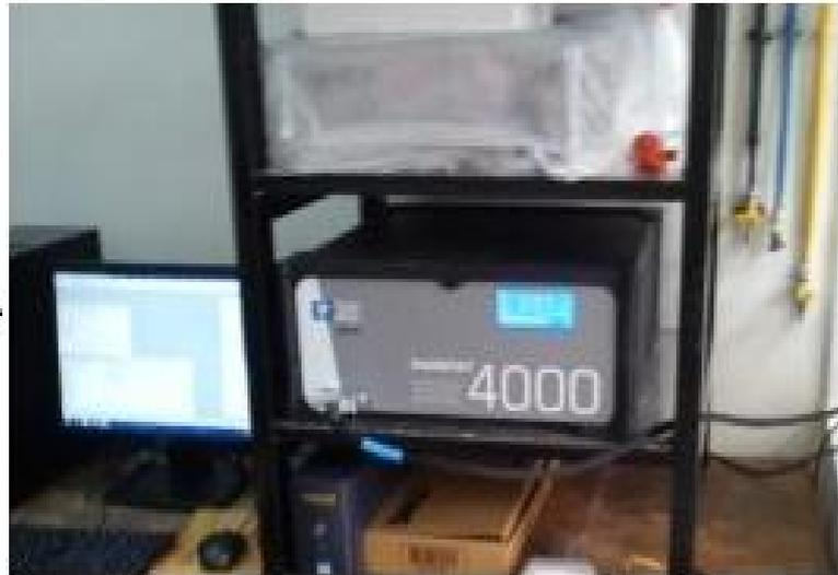
**Figure III.6.5.1** : photo du Potentiostat /Galvanostat
