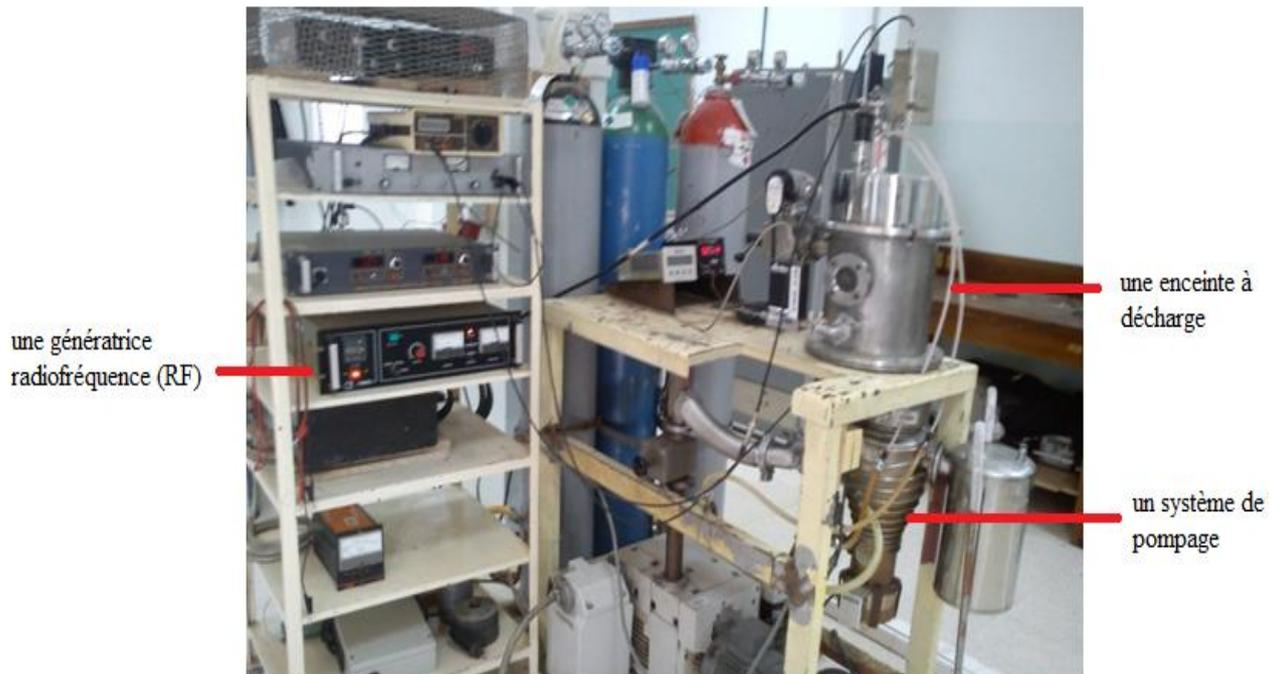
**Figure III.5. :** photographie du dispositif de dépôt.
