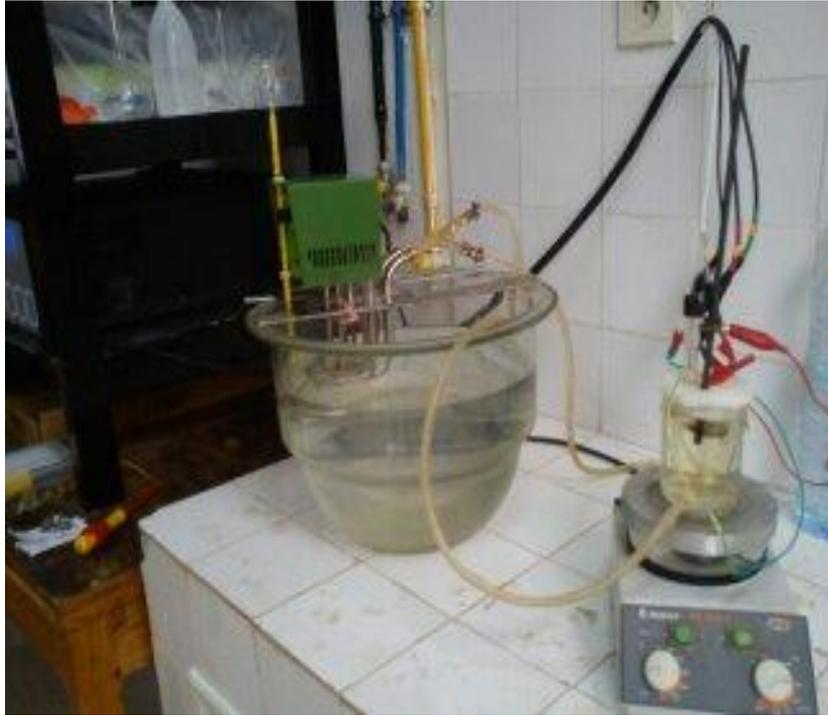
**Figure. III.6.5.2:** Cellule à trois électrodes.
