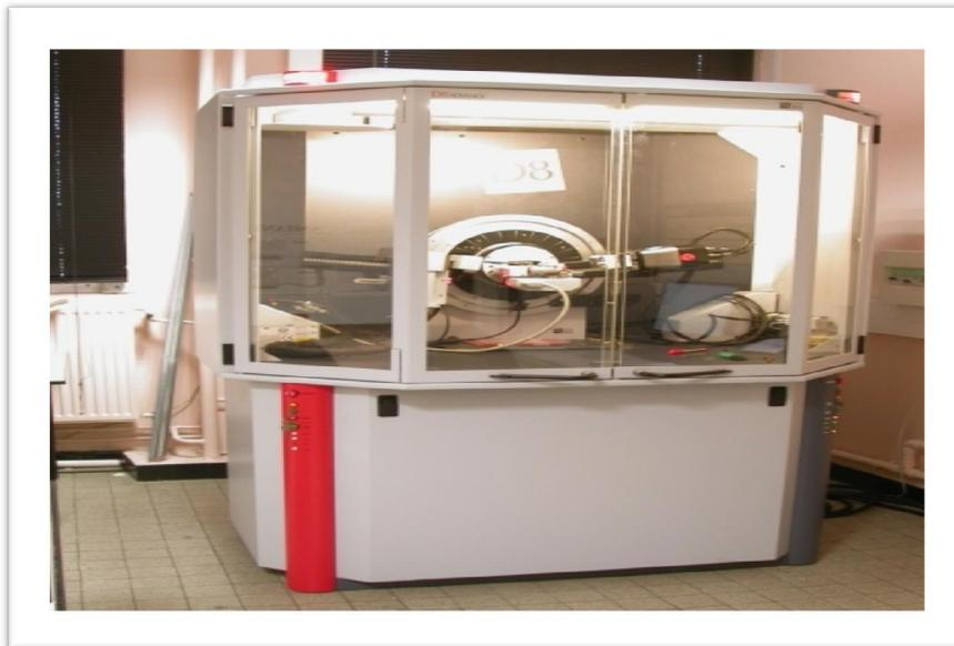
**Figure III.6.3.2 :** Diffractomètre BRUKER AXE D8 ADVANCE.
