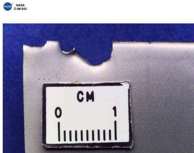
Figure :II.14. Endommagement d'une aube lié au pompage (Stein).
