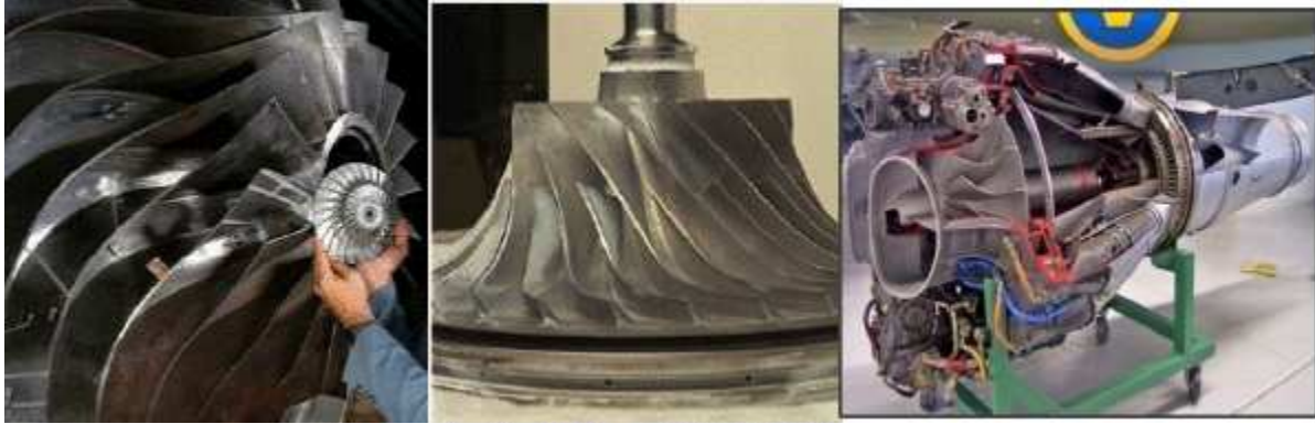
Figure: I.1. Compresseur radial (centrifuge).
