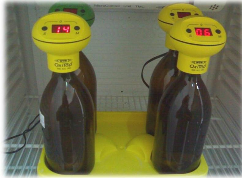
**Figure 4.13** Dispositif expérimental de la mesure de la DBO<sub>5</sub>.
