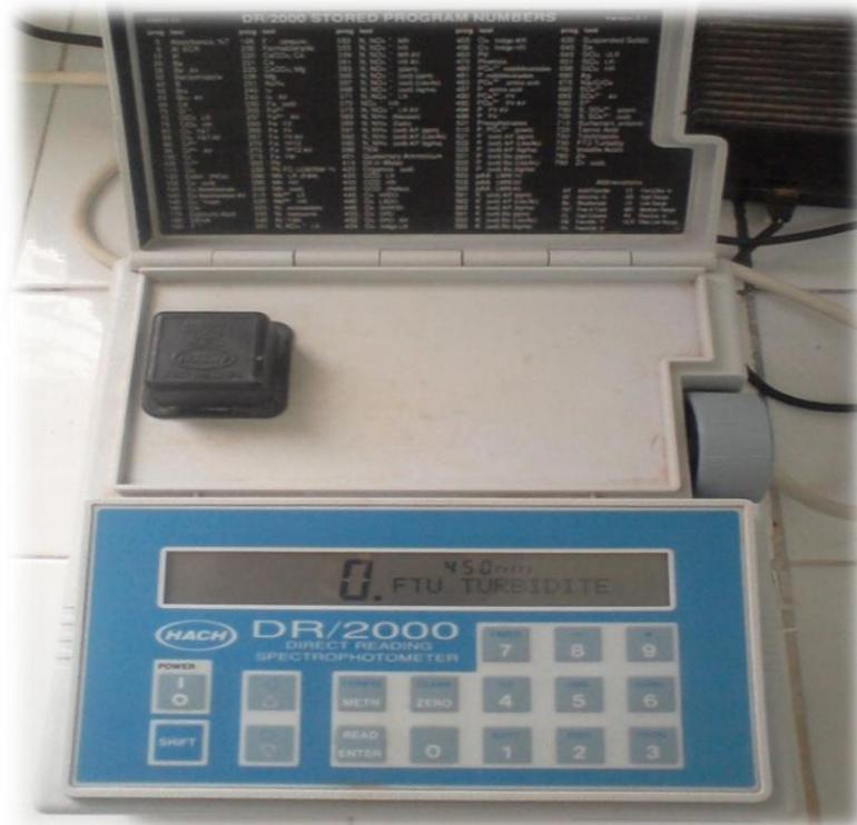
Figure 4.8 Spectrophotomètre DR/2000.
