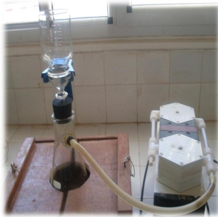
**Figure 4.2** Dispositif de filtration sous vide.
