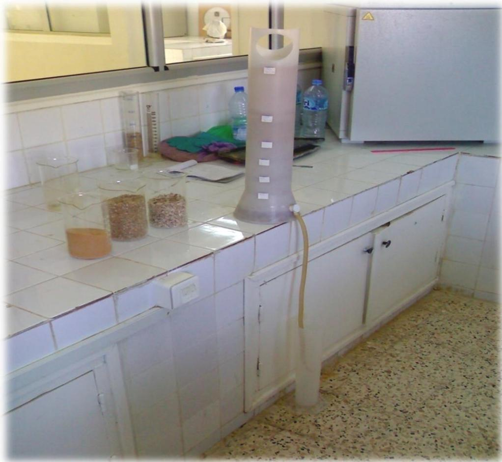
**Figure 4.15** Dispositif expérimental de la filtration sur sable.
