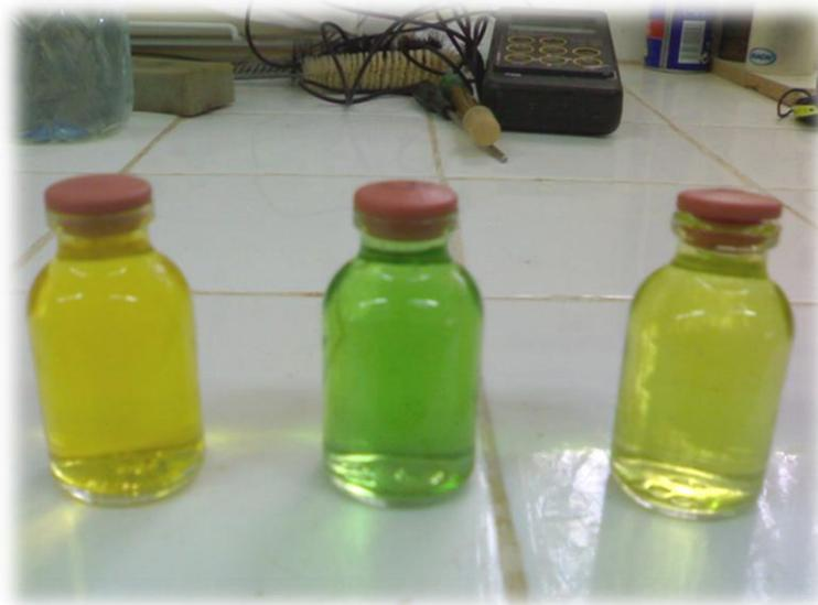
**Figure 4.6** Détermination de l'azote ammoniacal par colorimétrie.
