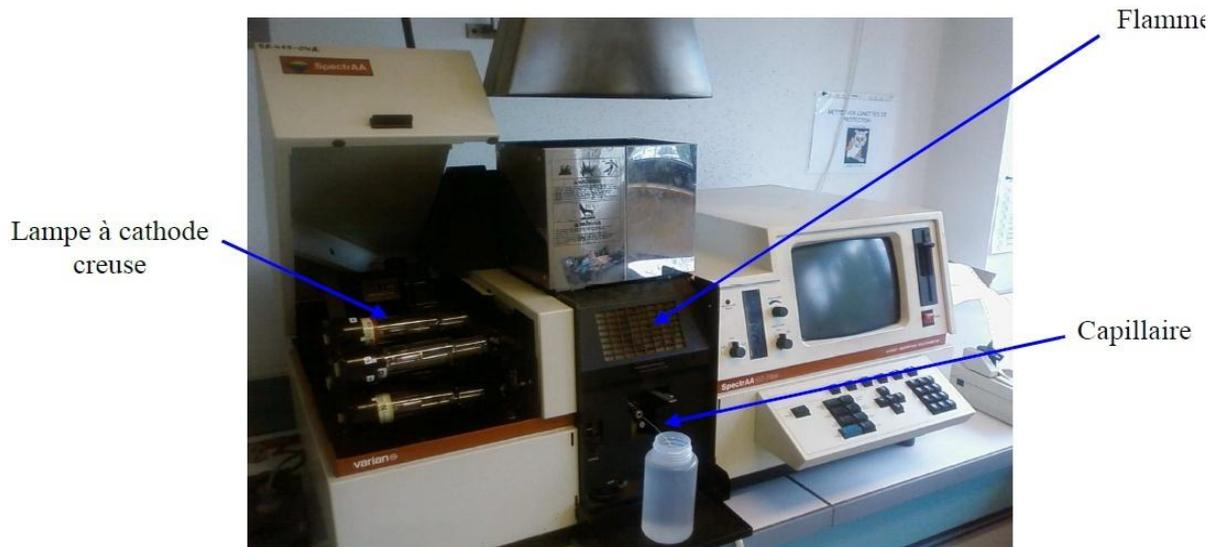
Figure IV.2 : spectrophotomètre d'absorption atomique
