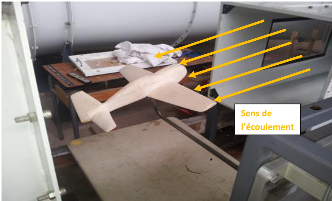
FIG.V.16 Mise en place du drone dans la veine d'essai.
