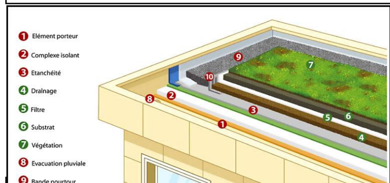
Fig79 (VI.8) : schéma d'une toiture terrasse extensive Src : developpement-durable.gouv.fr
