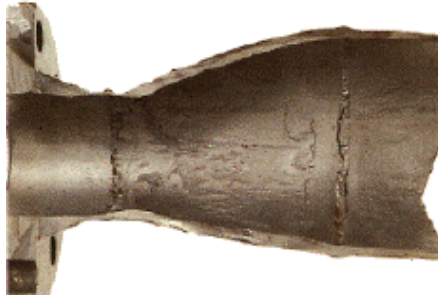
Fig.2.3. Corrosion par érosion
