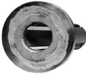
Fig.1.5. Corrosion par crevasse sous un joint.
