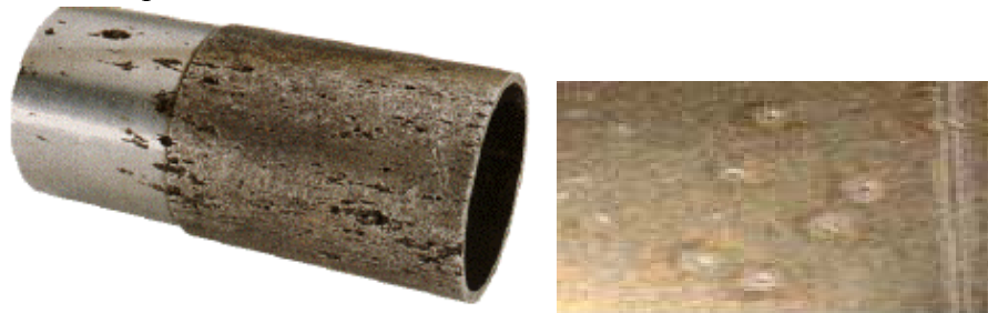
Fig.1.3. Corrosion par piqûre d'un acier inoxydable généralisée ou uniforme des pièces en acier.
