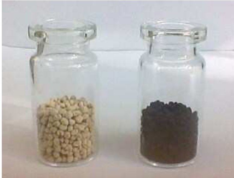
Figure III.1 : Photographie numériques des graines (CIMEG-AI) (à gauche) : avant adsorption ; (à droite): après adsorption
