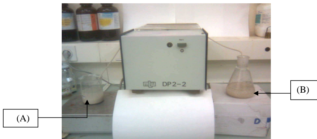
Figure. II.1 : Schéma du dispositif expérimental illustrant la préparation des billes gélifiées.
