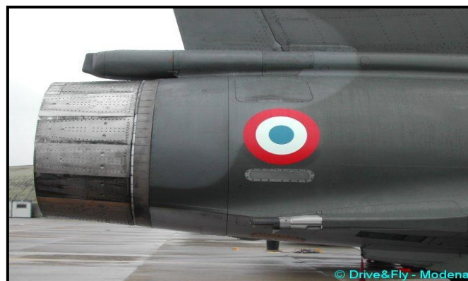
Fig. II.5 : Tuyère à section variable.
