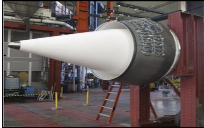
Fig. II.4 : Tuyère à noyau centrale.
