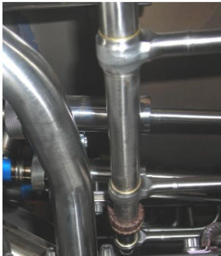
Figure (II-16) : La rampe carburant.
