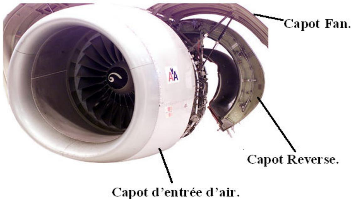
**Figure (I-3) : Les capotages du moteur.**
