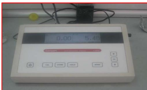
Figure II.7 Multi-paramètre type Consort C3010.
