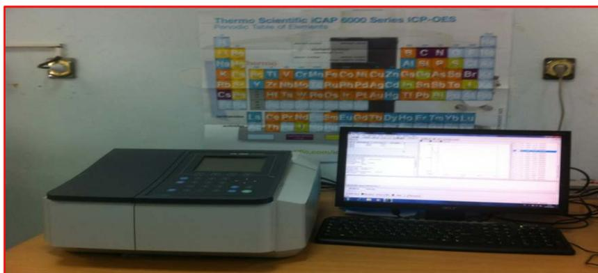
Figure II.6. Spectromètre UV-Visible à double faisceau de type Shimadzu UV1800
