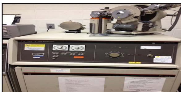
**Figure II.4.** Appareil mesures de la diffraction des rayons X.
