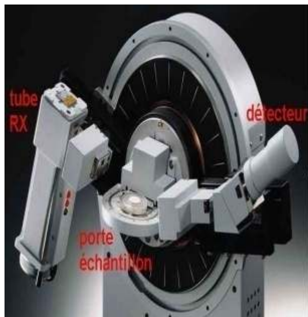
Figure II-7 : Vue schématique du montage de la DRX
