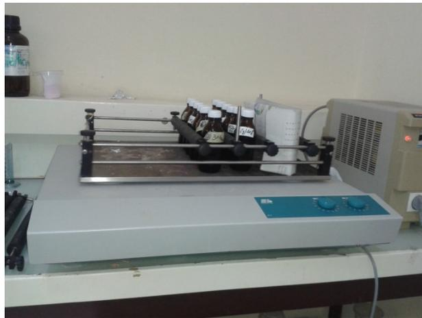
**Figure 3.4 :** image représentatif d'un secoueur. (Edmund Buhler GmbH SM-30)
