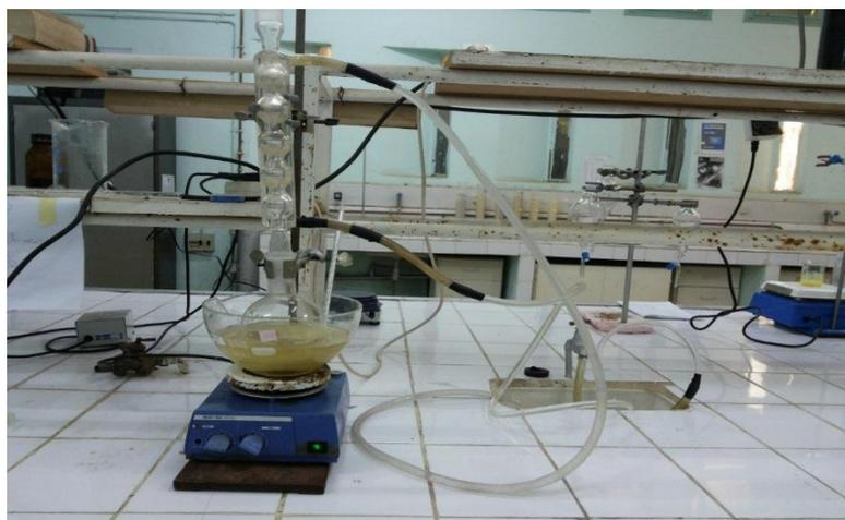
Figure V.1. Installation de prétraitement de l'alfa.
