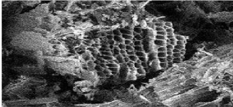
**Figure II.1** : Structure du charbon actif vu sous un microscope électronique [32].
