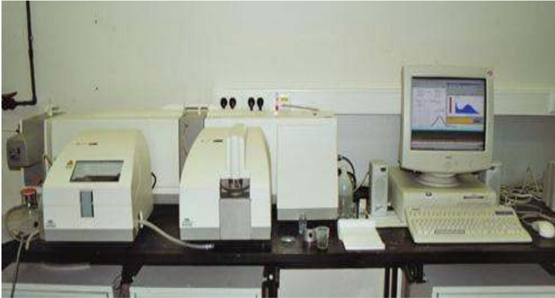
**Figure III.5. Granulomètre laser Mastersizer 2000**
