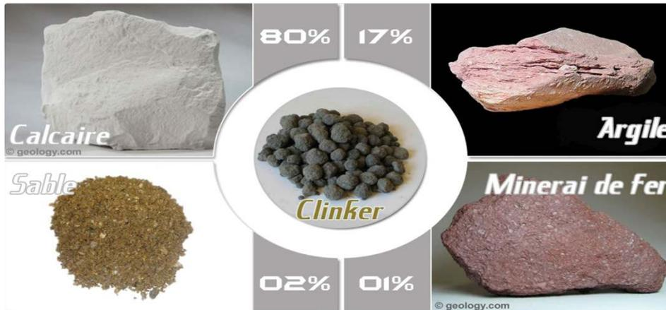
**Figure I.2 : Le calcaire, l'argile, le minerai de fer, et le sable d'une cimenterie**
