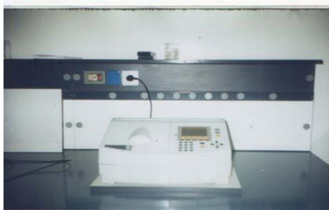
Figure5.3 : Spectrophotomètre utilisé pour la mesure de la densité optique du PA.
