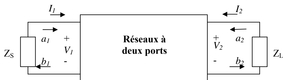
Figure 14 : Représentation du diagramme de paramètres [S] d'un réseau à deux ports.
