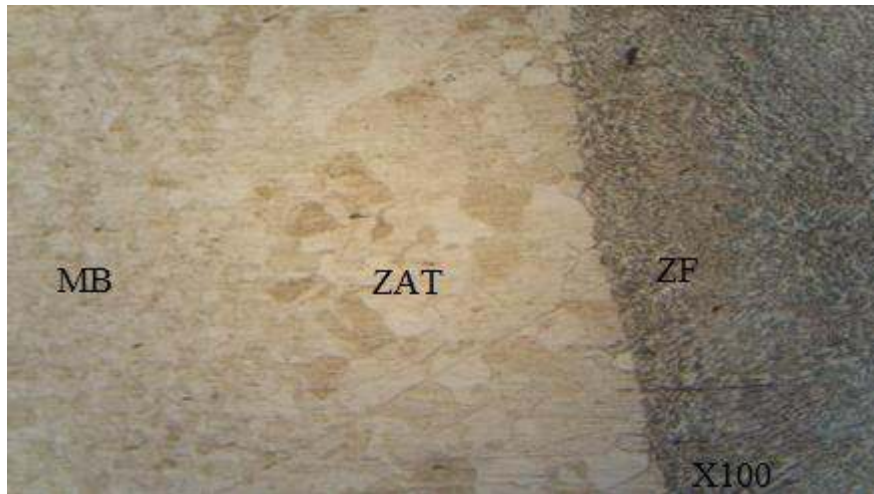
Figure IV.6. Zones de soudure de l'acier inoxydable 316L soudé.
