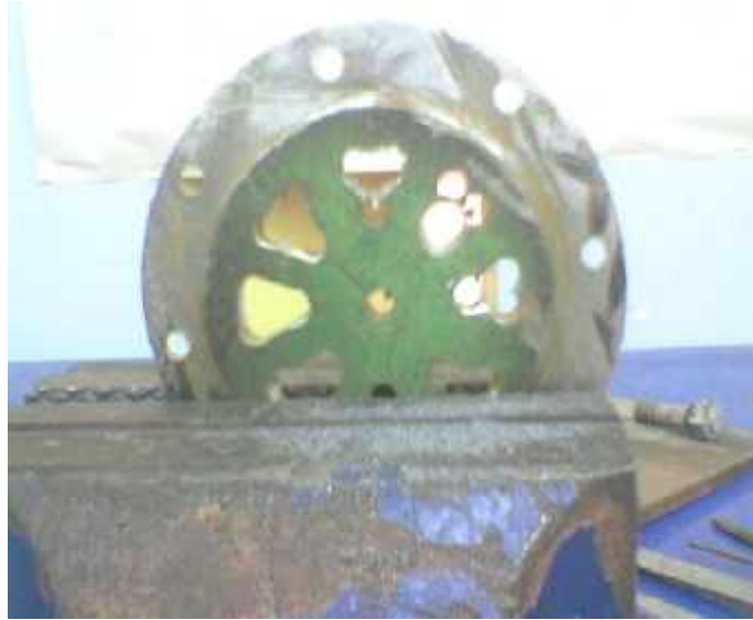
Fig. (4-17) bride des clapets au court d'usinage
