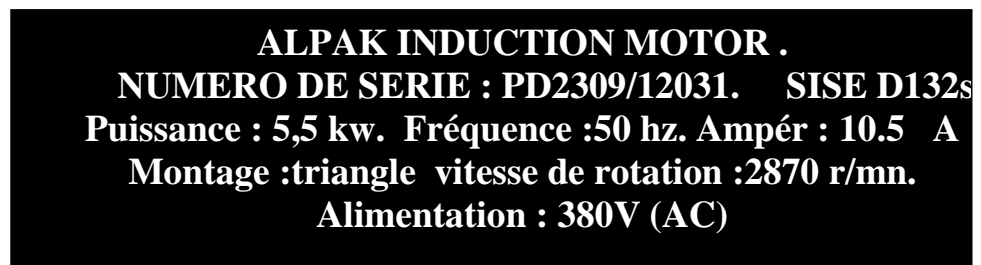
Fig. (4-37) identification du moteur électrique
