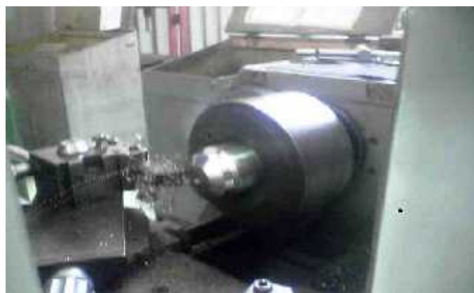
Fig. (4-24) opération de chariotage conique
