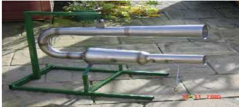
Fig. (1-15) pulsoréacteur sans valves
