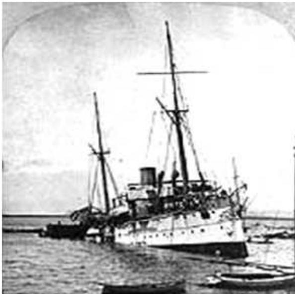
**Fig. I.7:** Conséquences d'un explosion de la chaudière sur un Navire, 1905 à San Diego California, l'explosion était due à l'éclatement d'une Soupape de sûreté [32].
