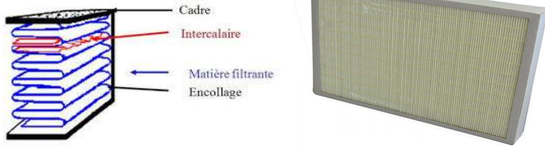
Fig5 : la structure d'un filtre HEPA
