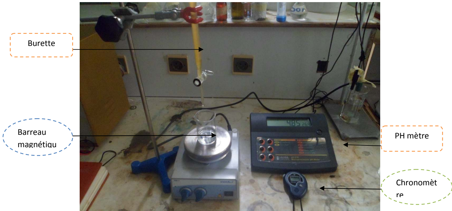
Figure III.7 : Montage du profil neutralisation
