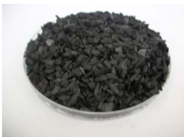
Figure 3.2 : Adsorbants utilisés (charbon actif)
