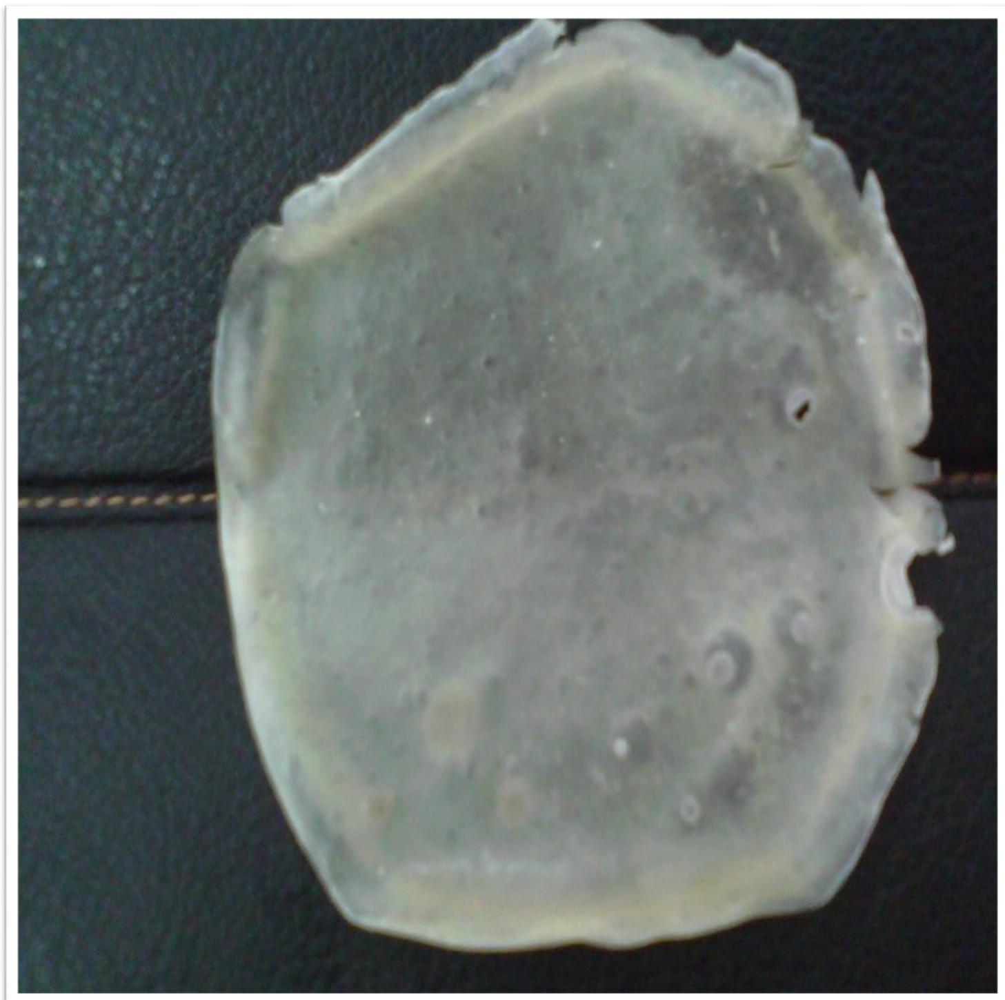
**Membrane SBR chlorométhylé quaternisé réticulé**
