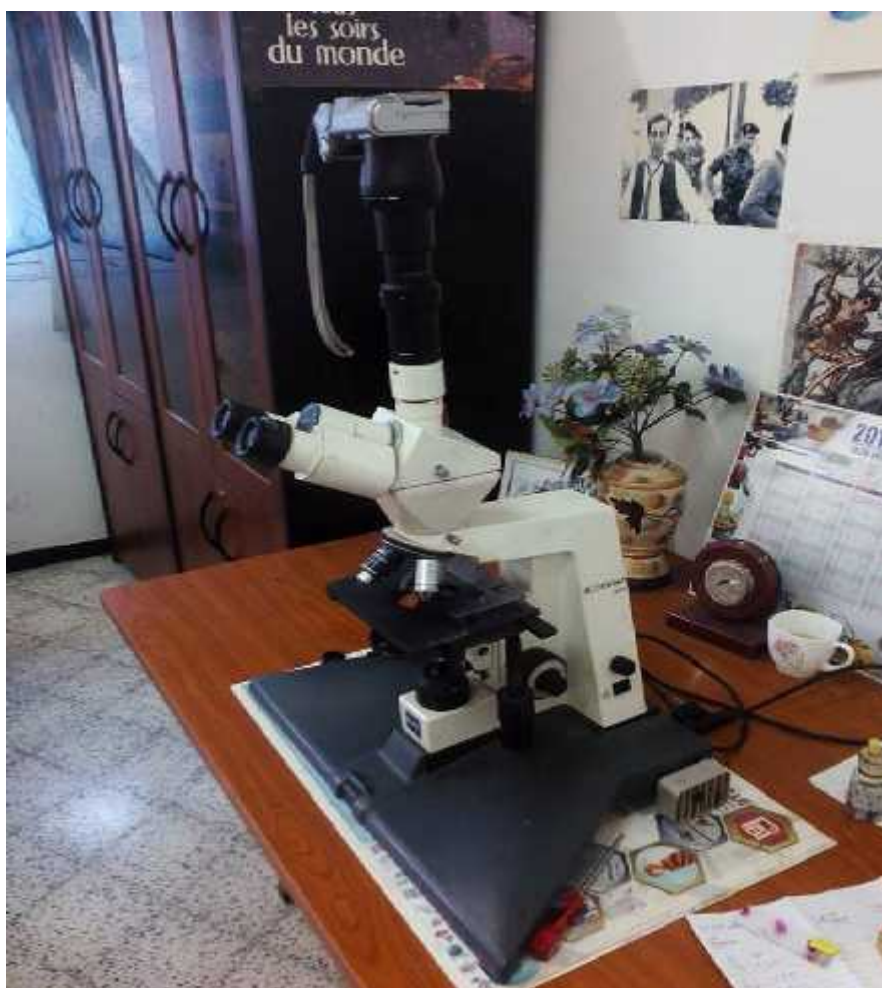
Figure 8 : Appareil numérique adapté à un microscope photonique.
