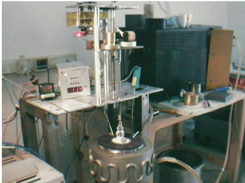
Figure 4.2: Four Cz réalisé au laboratoire
