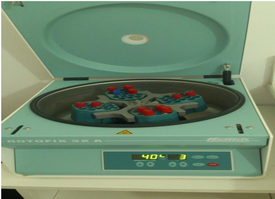
**Figure 11** : centrifugation des prélèvements a 4000 tours /min pendant 3 min
