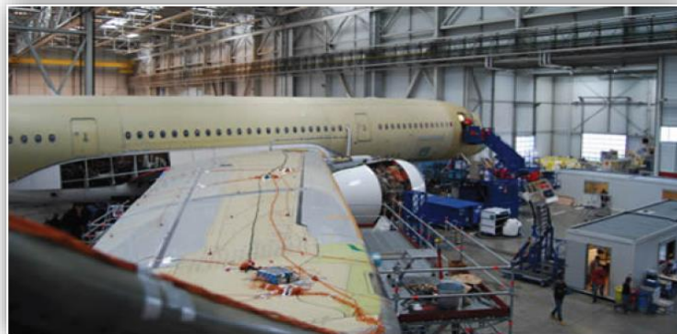
Figure 1.7 L'A350 XWB lors des essais de vibrations au sol.
