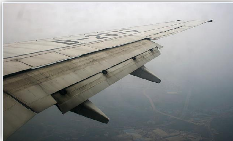
Figure I.8 Volets sortis en préparation de l'atterrissage [37].
