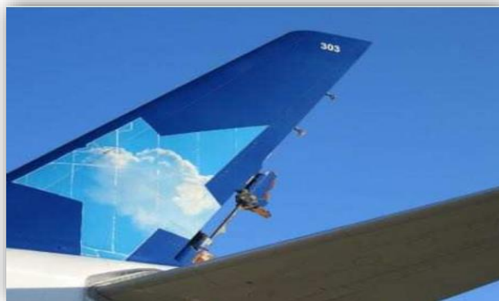
Figure I.6 Arrachement de la gouverne de direction d'un Airbus A310-300 suite à du flottement.
