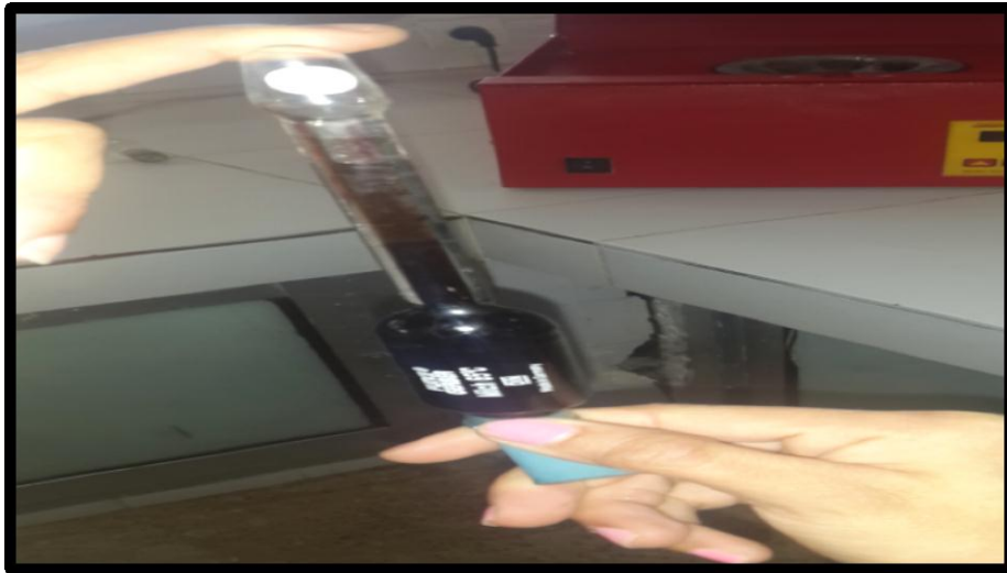
Figure 05 : Technique de lecture de teneur en MG
