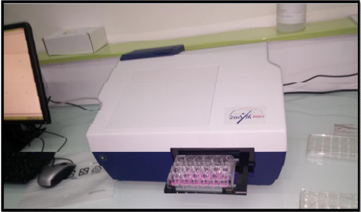
Figure 8 : Lecture des DO sur un lecteur de microplaques
