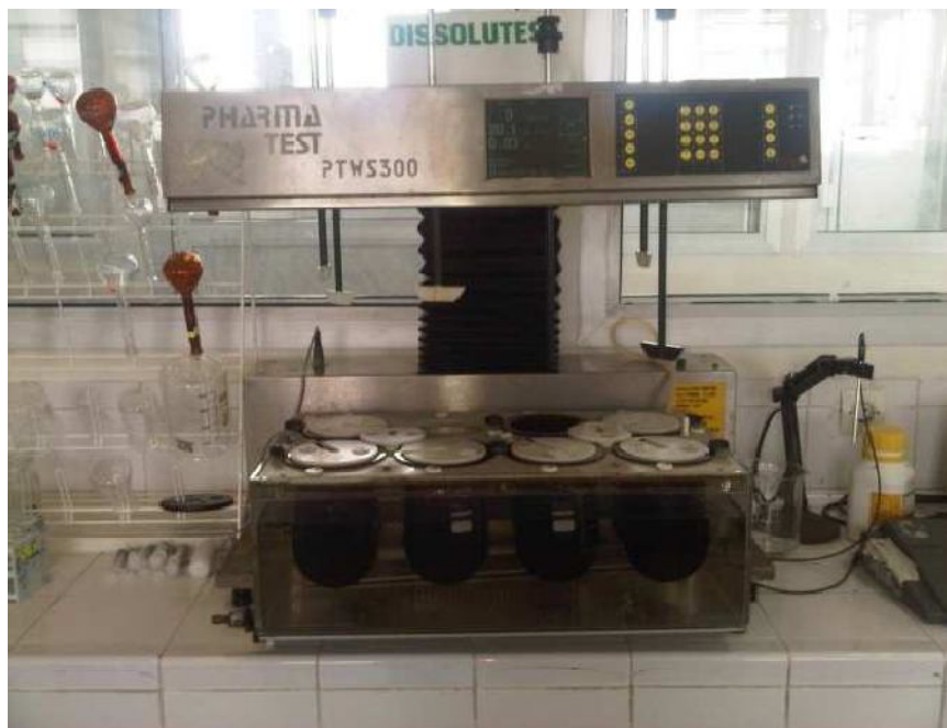
Figure IV-8 : Dissolutest à palettes type Pharma Test PTWS 300
