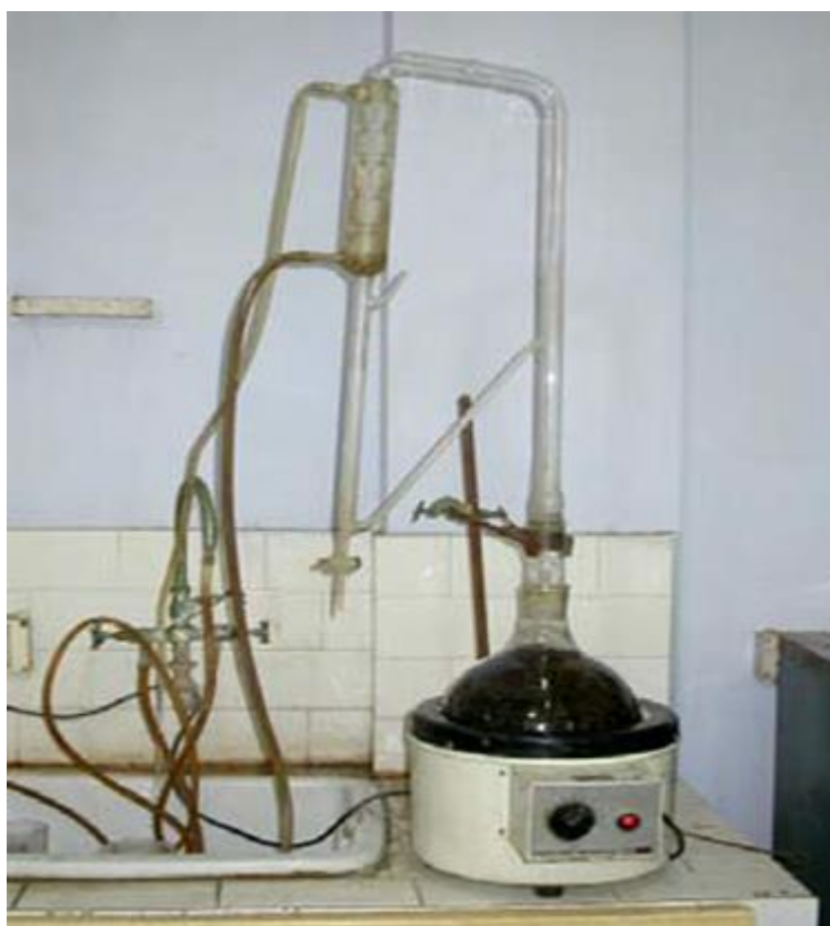
Figure 26 : Dispositif d'extraction des HE par hydrodistillation type Clevenger.
