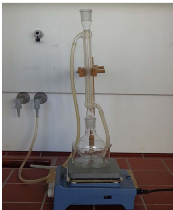
Figure 19: Dispositif de l'extraction des métaux lourds à reflux
