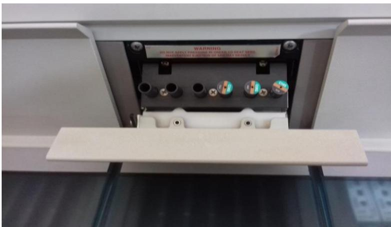
Figure 3 : L'emplacement dans l'instrument les cartouches "CORS"
