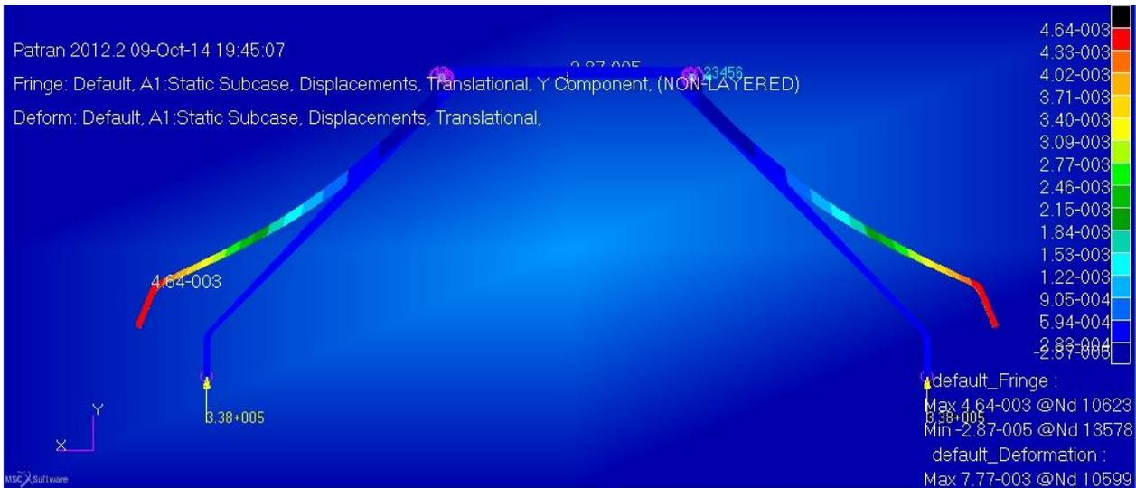
Fig.IV .2 déformation de train suivant Y
