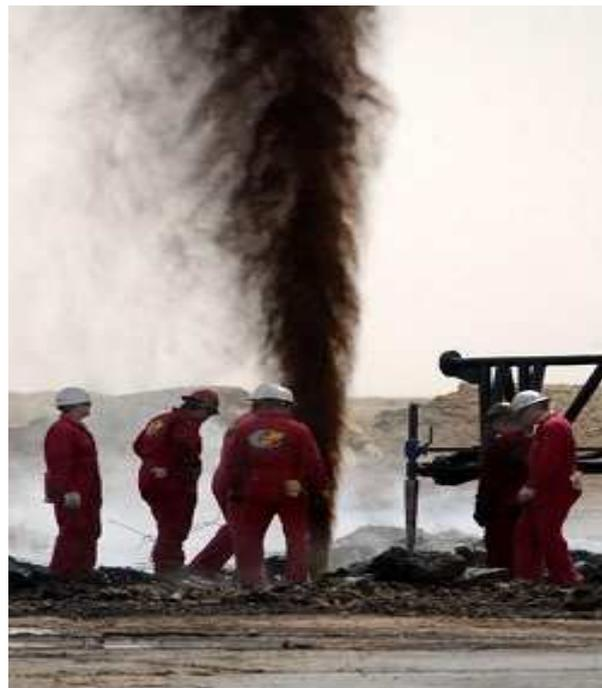
**Figure I.2** Photo : Pétrole jaillissant naturellement de la roche réservoir sous l'effet de la pression.
