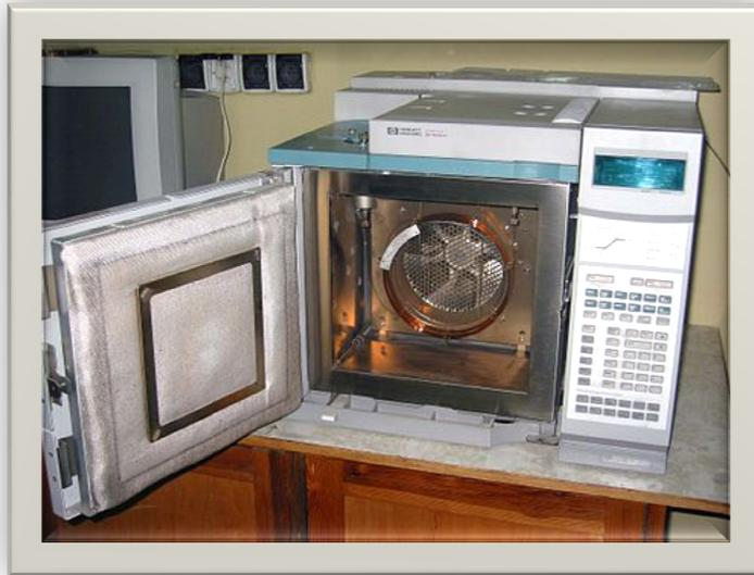
**Figure N°II.1 :**Vue de l'intérieur du four avec la colonne chromatographique.
