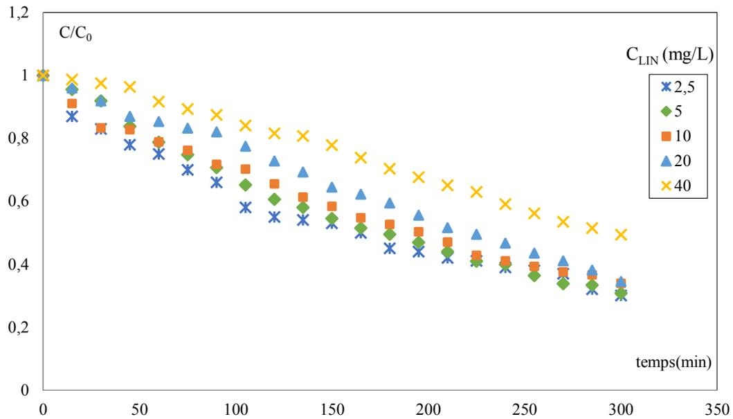
Figure III.28: Evolution temporelle de la concentration réduite du linuron pour différentes concentrations initiales en polluant (ZnO /UV lampe).
