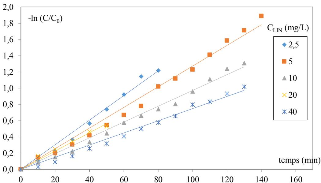
FigureA.IV.6 : Evolution temporelle de  $-\ln(C/C_0)$  pour différentes concentrations en linuron ( $\text{TiO}_2/\text{UV Solaire}$ ).  $C_{\text{TiO}_2}=0.3\text{mg/cm}^2$ ,  $Q=60 \text{ mL/s}$ , pH libre.
