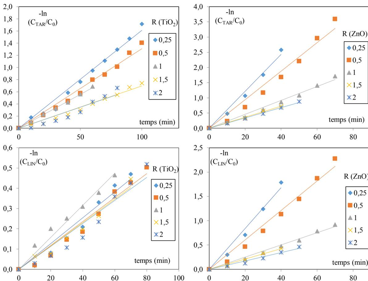
Figure.A.IV.10 : Evolution temporelle de  $-\ln(C/C_0)$  différentes R lors de la codégradation de la tartrazine et le linuron (ZnO et TiO<sub>2</sub>/UV Solaire).  $C_{CAT}=0,3 \text{ mg/cm}^2$ ,  $C=10\text{mg/L}$ ,  $Q= 60 \text{ ml/s}$ , pH libre.
