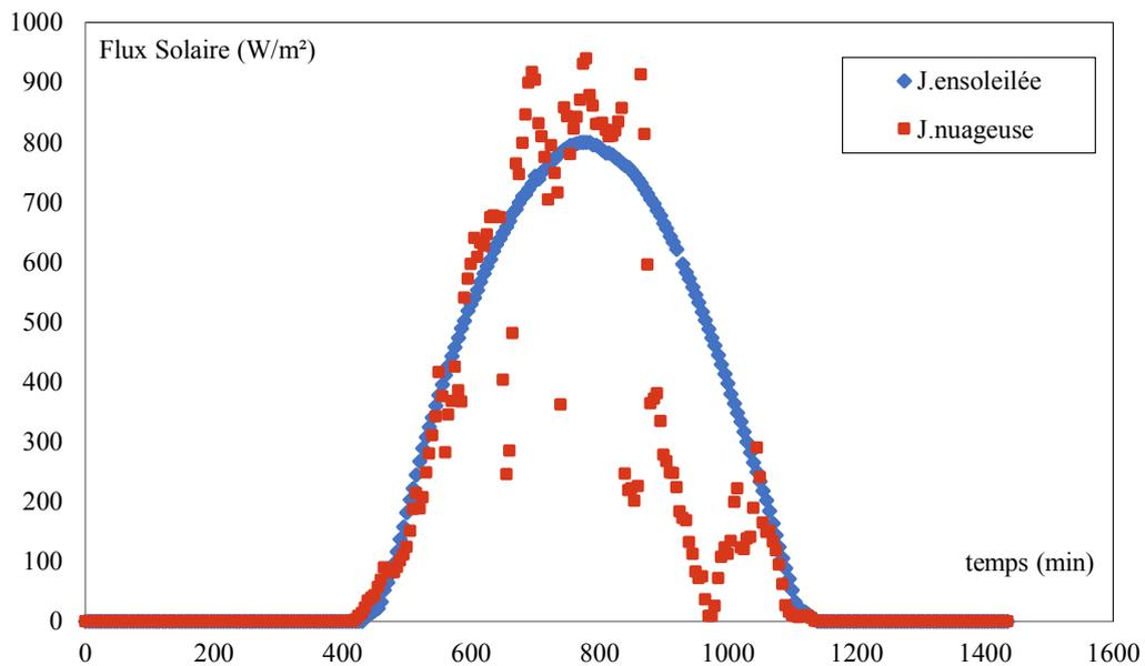
Figure III.3: Evolution temporelle du flux solaire.
