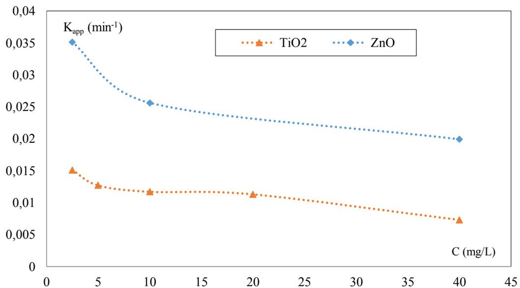
Figure III.15: Evolution de la constante apparente de vitesse en fonction de la concentration initiale en linuron (TiO<sub>2</sub>, ZnO /UV Solaire).
