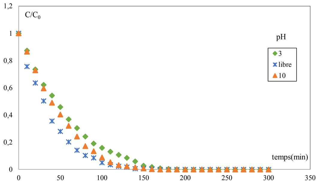
Figure III.18: Evolution temporelle de la concentration réduite de linuron pour différents pH. (ZnO/UV Solaire). C<sub>LIN</sub>=10 mg/L; C<sub>ZnO</sub>= 0,3 mg/cm<sup>2</sup> ; Q =60 mL/s .
