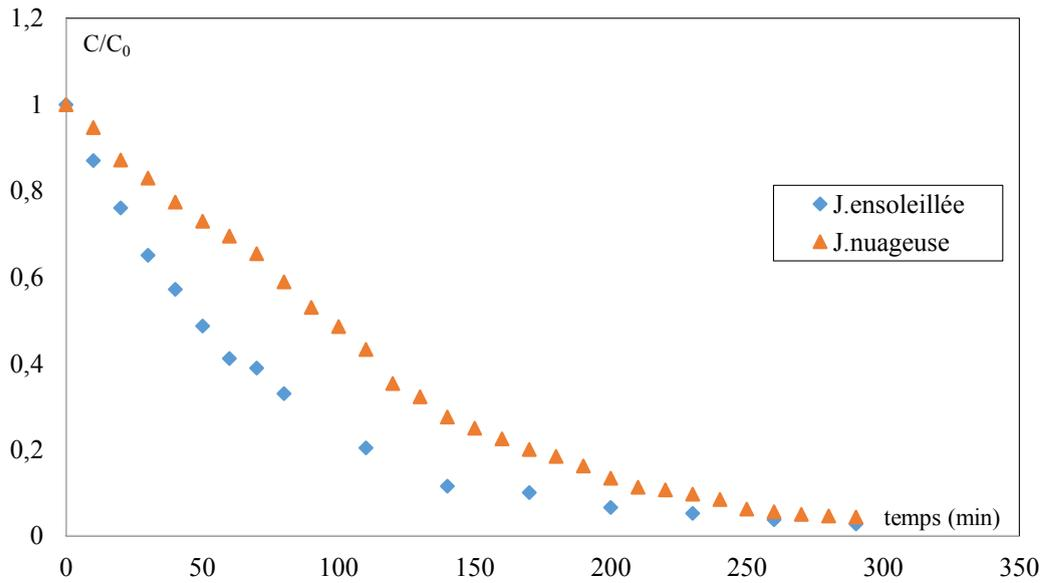
Figure III.2: Evolution temporelle de la concentration réduite de la tartrazine pour différents flux solaire ( $TiO_2$  /UV Solaire).  $C_{TAR}=10 \text{ mg.L}^{-1}$ ;  $C_{TiO_2}= 0,3 \text{ mg/cm}^2$ .
