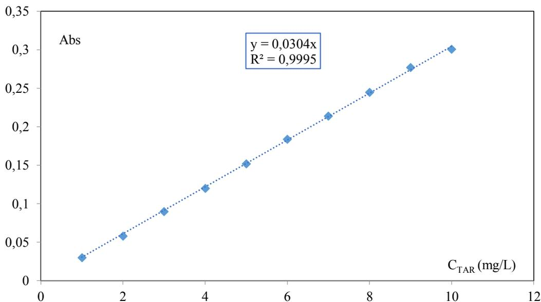
Figure A.III.2. Courbe d'étalonnage de la tartrazine
