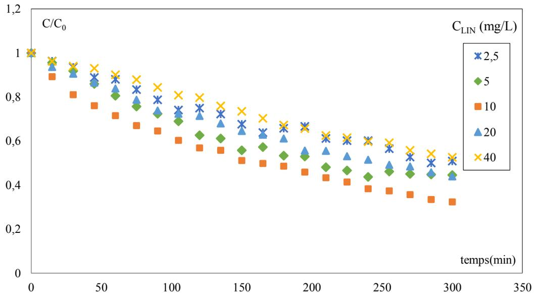
Figure III.27:Evolution temporelle de la concentration réduite du linuron pour différentes concentrations initiales en polluant (TiO<sub>2</sub>/UV lampe)
