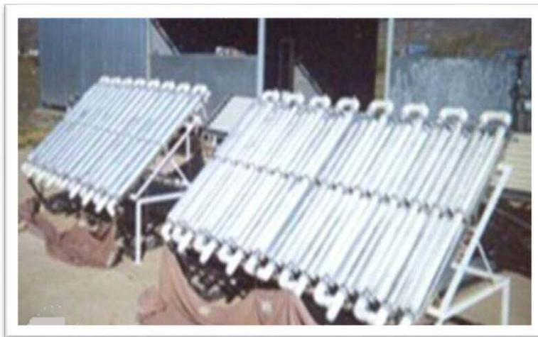
Figure I.14:Photoreacteur à faible concentration photonique.
