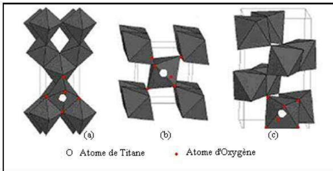
Structure des différentes phases cristallines de TiO<sub>2</sub>
