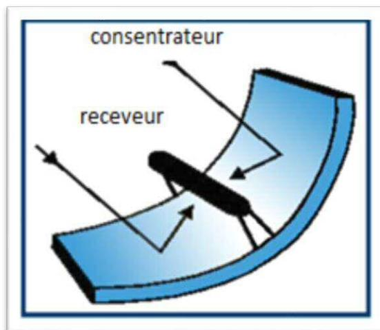
Figure I.11: Schéma d'un collecteur solaire parabolique.
