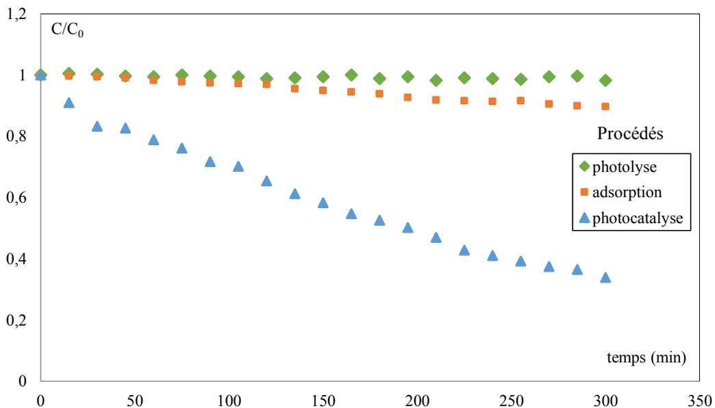
Figure III.26. Evolution temporelle de la concentration réduite du linuron pour différents procédés ( $ZnO$  /UV lampe).  $C_{TAR}=10$  mg/L ,  $C_{ZnO}= 0,3$  mg/m<sup>2</sup> ; pH libre.
