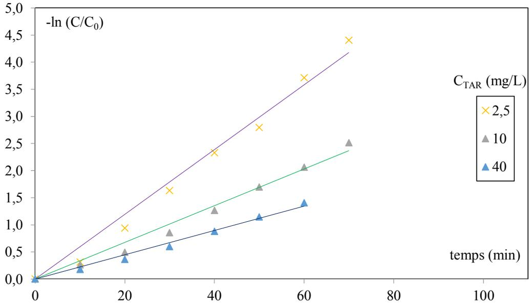
Figure III.7: Evolution temporelle de  $-\ln(C/C_0)$  pour différentes concentrations en Tartrazine (TiO<sub>2</sub>/UV Solaire).  $C_{ZnO} = 0.3 \text{ mg/cm}^2$ ,  $Q = 60 \text{ mL/s}$ ,  $Q = 8 \text{ L}$ , pH libre.
