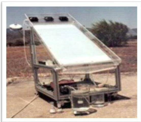
Figure I.12 : Photoreacteur à lit fixe.
