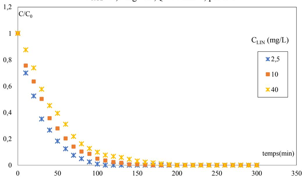
Figure III.14: Evolution temporelle de la concentration réduite de linuron pour différents concentrations initiales en polluant ( $ZnO$ /UV Solaire).
