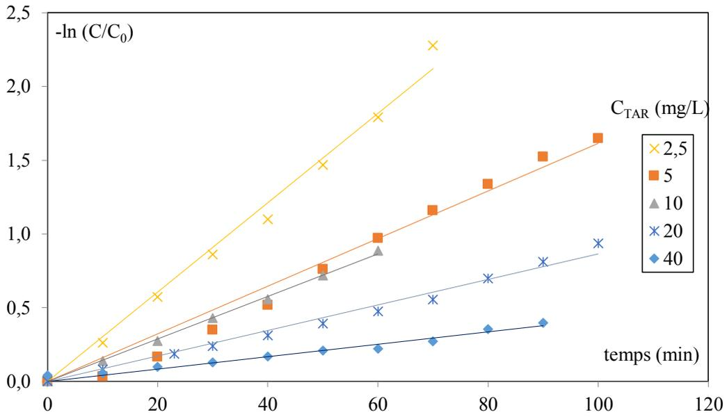
Figure III.6: Evolution temporelle de  $-\ln(C/C_0)$  pour différentes concentrations en tartrazine (TiO<sub>2</sub>/UV Solaire).  $C_{TiO_2} = 0.3 \text{ mg/cm}^2$ ,  $Q = 60 \text{ mL/s}$ ,  $Q = 8 \text{ L}$ , pH libre.
