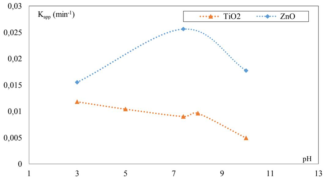
Figure III.19:Évaluation de la constante apparente de vitesse pour différents pH pour les deux types de catalyseurs (TiO<sub>2</sub> et ZnO).
