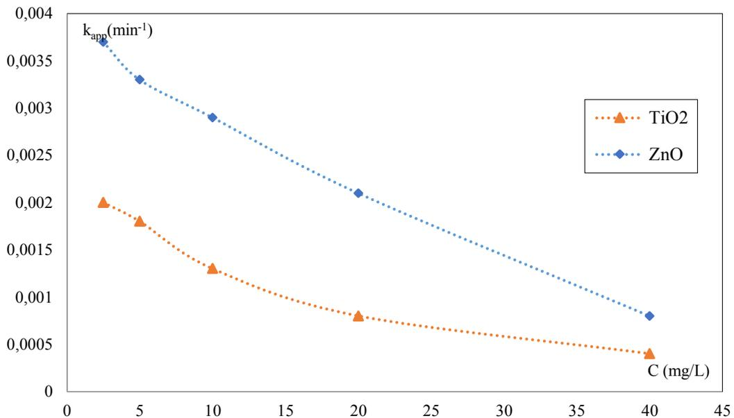
Figure III.25 : Evolution de la constante apparente de vitesse en fonction de la concentration initiale en tartrazine (TiO<sub>2</sub>, ZnO /UV lampe).
