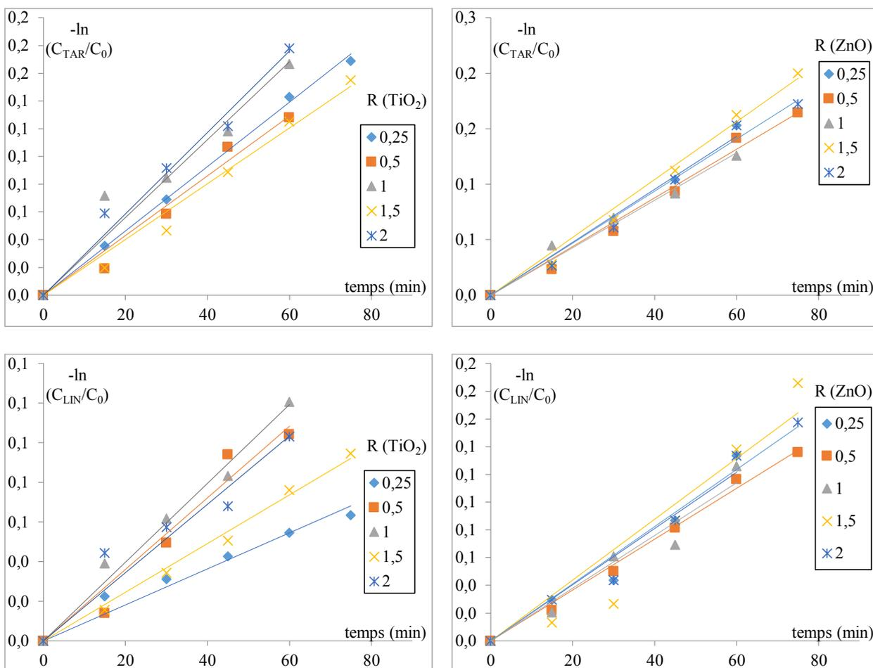
Figure.A.IV.16 : Evolution temporelle de  $-\ln(C/C_0)$  différentes R lors de la codégradation de la tartrazine et le linuron (ZnO et TiO<sub>2</sub>/UV lampe).
