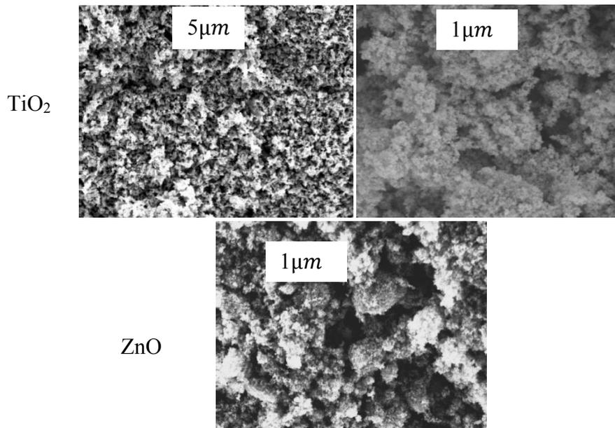
Photographie des grains de TiO<sub>2</sub> et de ZnO obtenues par Microscopie Electronique à Balayage (MEB).
