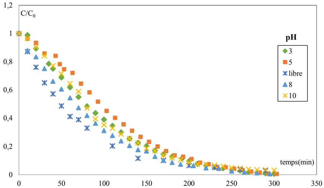
Figure III.10: Evolution temporelle de la concentration réduite de la tartrazine pour différents pH. ( $\text{TiO}_2/\text{UV}$  solaire).  $C_{\text{TAR}}=10 \text{ mg/L}$  ;  $C_{\text{TiO}_2}=0,3 \text{ mg/cm}^2$  ;  $Q =60 \text{ mL/s}$ .
