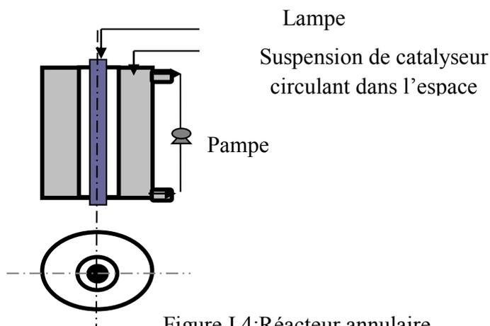
Figure I.4: Réacteur annulaire.
