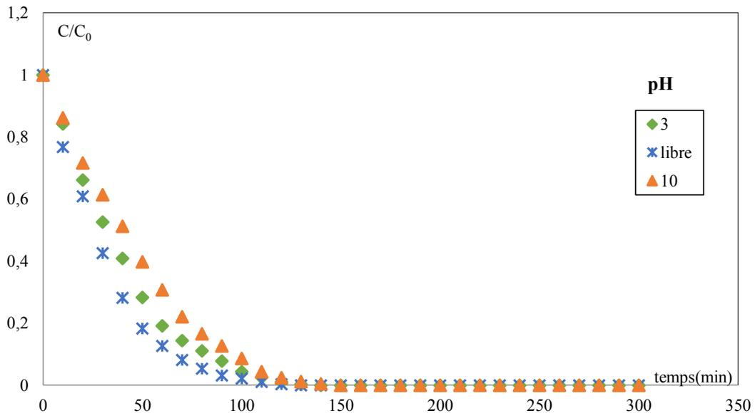
Figure III.11: Evolution temporelle de la concentration réduite de la tartrazine pour différents pH. ( $\text{ZnO}/\text{UV}$  solaire).  $C_{\text{TAR}}=10 \text{ mg/L}$ ;  $C_{\text{ZnO}}=0,3 \text{ mg/cm}^2$ ;  $Q =60 \text{ mL/s}$ .
