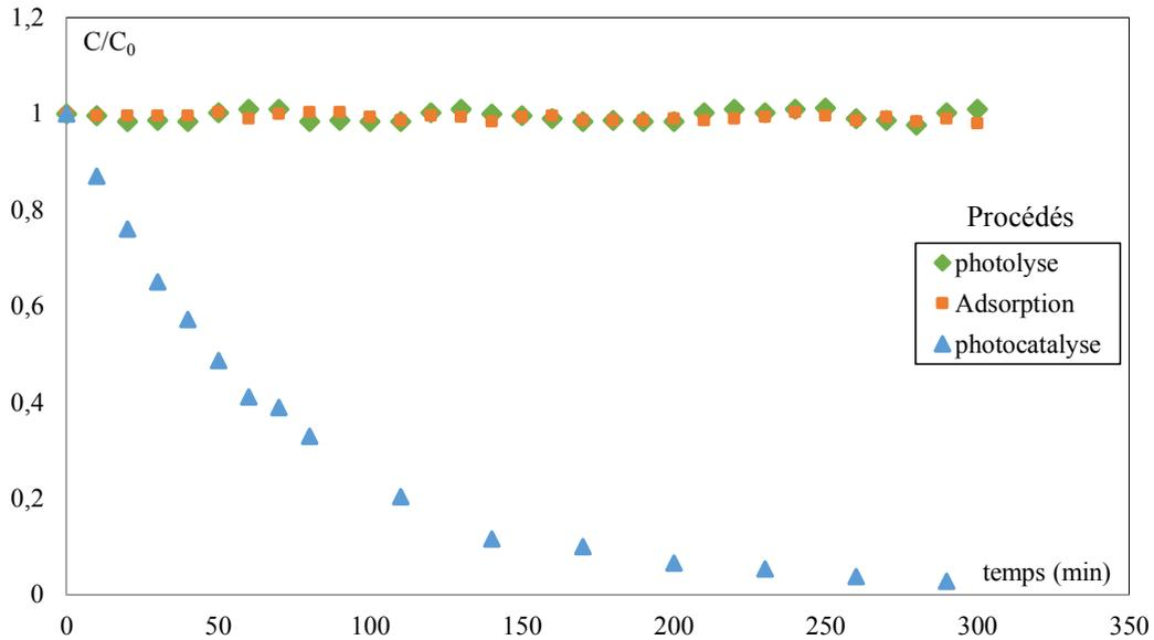
Figure III.1: Evolution temporelle de la concentration réduite de la tartrazine pour différents procédés (TiO<sub>2</sub>/UV Solaire). C<sub>TAR</sub>=10 mg.L<sup>-1</sup>, C<sub>TiO<sub>2</sub></sub>= 0,3mg/cm<sup>2</sup> ; pH libre.
