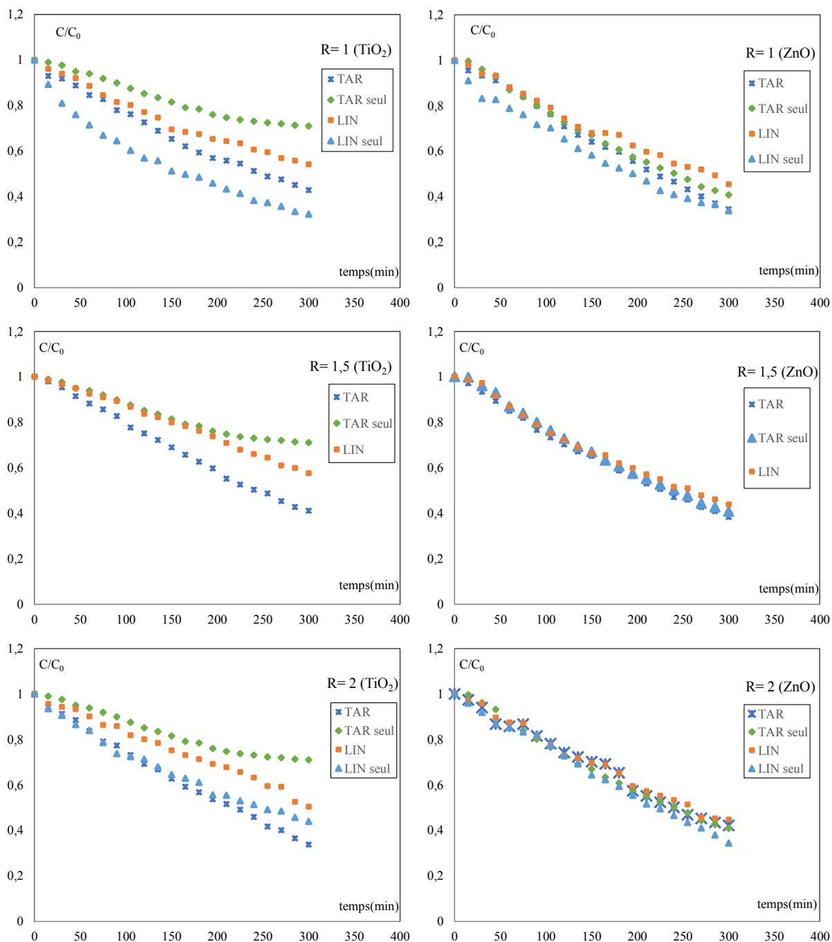
Figure.III.30: Evolution temporelle de la concentration réduite de la tartrazine et du linuron pour différents rapports massiques pour les deux catalyseurs ( $TiO_2$  et  $ZnO$ ) sous une irradiation UV artificiel.
