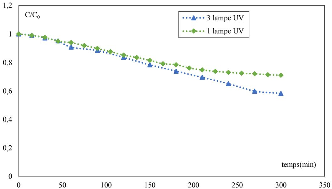
Figure.III.22:Evolution temporelle de la concentration réduite de la tartrazine pour 1 et 3 lampes U.V. (TiO<sub>2</sub>/UV lampe).
