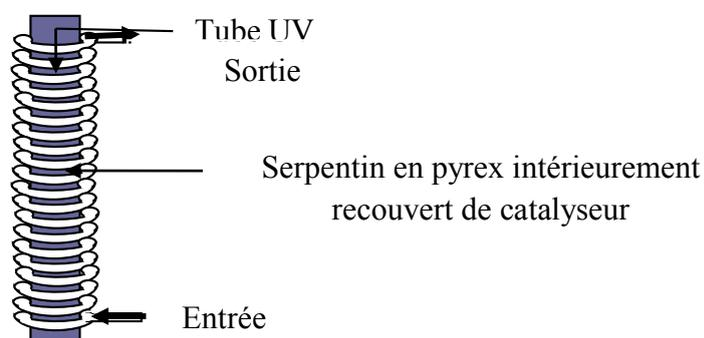
Figure I.8: Réacteur spirale.
