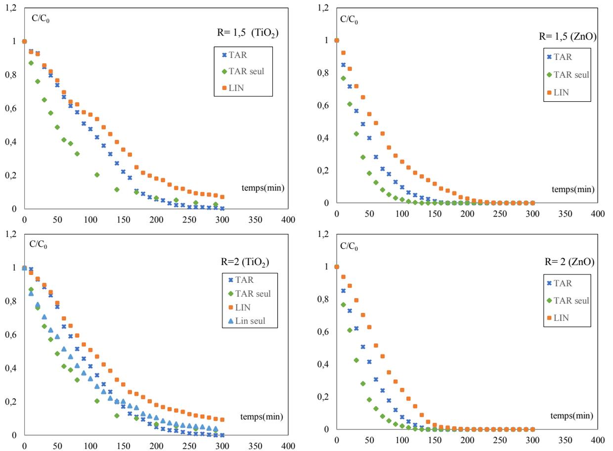
Figure.III.20 : Evolution temporelle de la concentration réduite de la tartrazine et du linuron pour différents rapports massiques pour les deux types de catalyseurs ( $\text{TiO}_2$  et  $\text{ZnO}$ ) sous une irradiation solaire.
