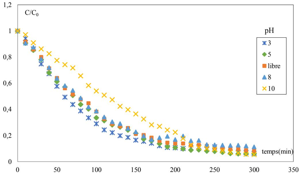
Figure III.17: Evolution temporelle de la concentration réduite de linuron pour différents pH. (TiO<sub>2</sub>/UV Solaire). C<sub>LIN</sub>=10 mg/L; C<sub>TiO<sub>2</sub></sub>= 0,3 mg/cm<sup>2</sup> ; Q =60 mL/s.
