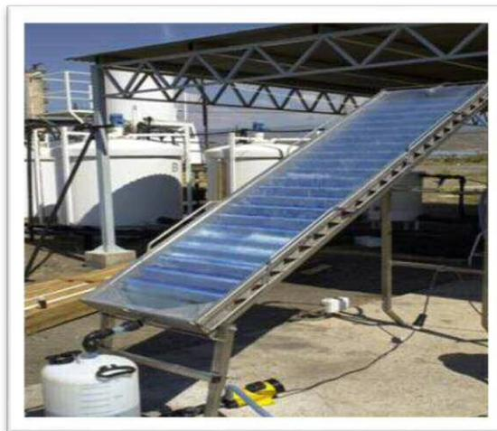
Figure I.13 : Photoreacteur à lit fixe
