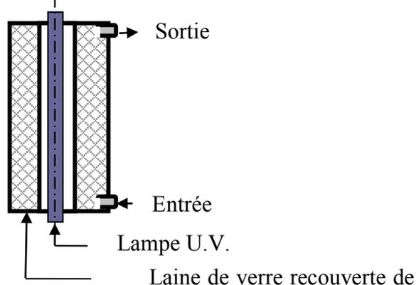
Figure I.6 : Réacteur annulaire avec garnissage de fibres de verre.
