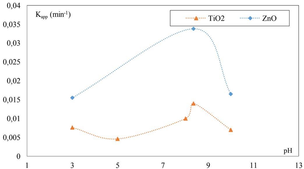
Figure III.12: Évaluation de la constante apparente de vitesse pour différents pH en présence des deux types de catalyseurs (TiO<sub>2</sub> et ZnO).
