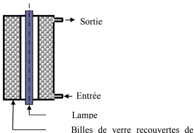
Figure I.7 : Réacteur annulaire garni d'un lit de billes de verre
