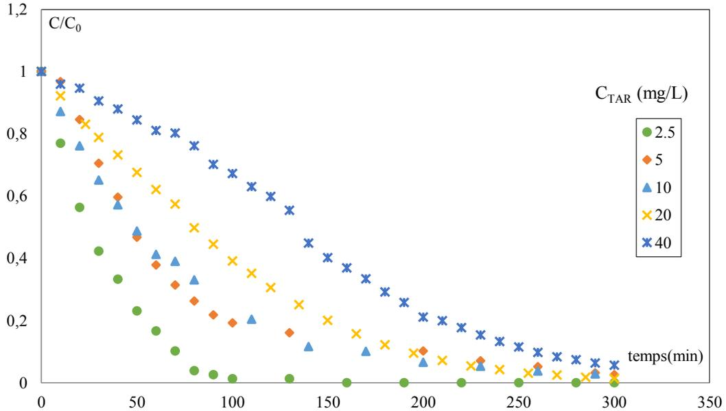
Figure III.4: Evolution temporelle de la concentration réduite pour différentes concentrations initiales en tartrazine (TiO<sub>2</sub>/UV Solaire).
