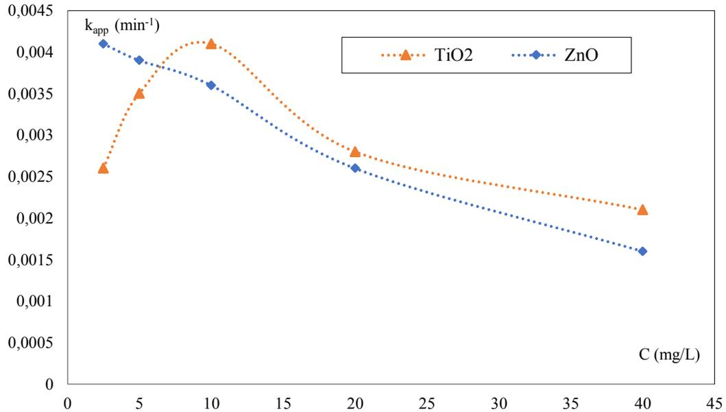
Figure III.29: Evolution de la constante apparente de vitesse en fonction de la concentration initiale en linuron (TiO<sub>2</sub> et ZnO /UV lampe)
