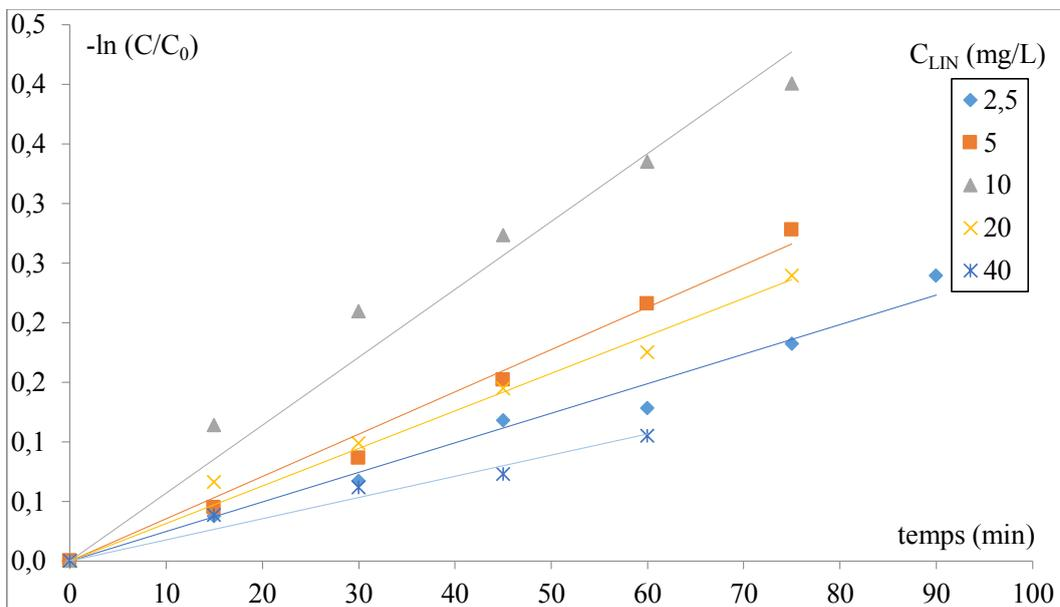
Figure A.IV.13: Evolution temporelle de  $-\ln(C/C_0)$  pour différentes concentrations en linuron (TiO<sub>2</sub>/UV lampe).
