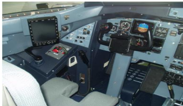
Figure.III.2 : Installation avec le clavier arrimé
