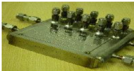
Figure 2.4: Microréacteur développé à l'Université de Bath [62].
