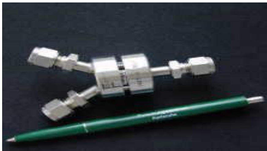
Figure 2.2 :Micro-mélangeur de type « cyclone » développé par le FZK [62].
